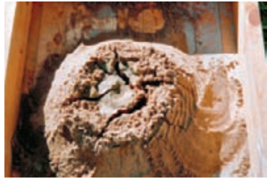
Stukasläckning av kalk där sanden omsluter kalken i släckningskedet.
