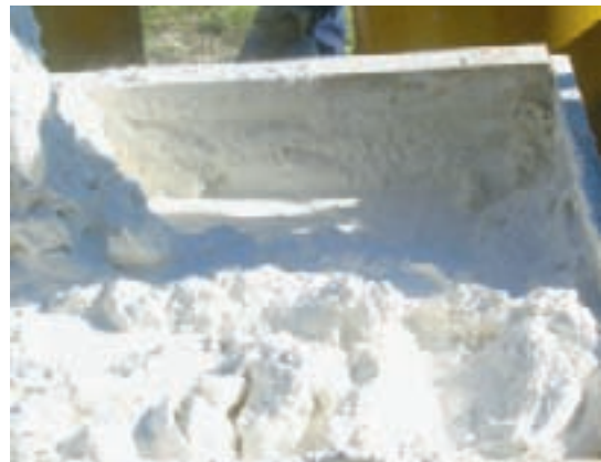
Våtsläckning av kalk ger en kalkpasta.
