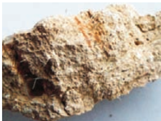
Ett bruk som består av mycket lera och djurhår från en fönsteromfattning.
