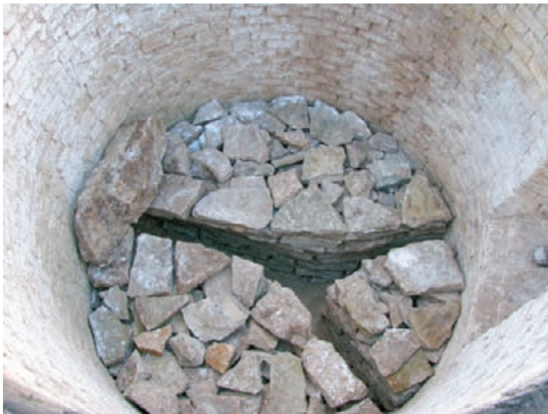
Traditionell tillverkning av kalk i vedeldad kalkugn.
