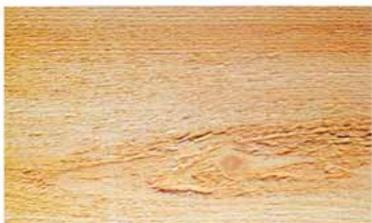
Fast, mjuk och lös röta (fig 12)
