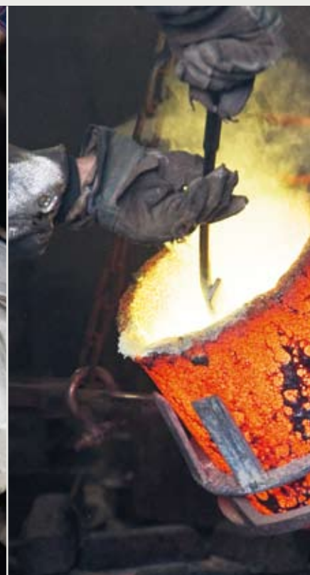
Grafitdegel med smält mässing.
