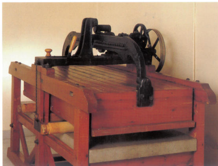
Stenmangeln i residensets källare från AT Antonssons Mangelfabrik i Malmö används fortfarande för att ge linnet den rätta finishen.
