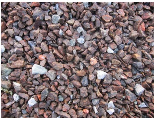
Makadam är krossat berg eller åsmaterial som sorteras i särskilda fraktioner.
